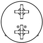
**Mezclador termostático de 1/2" - 1/2" para baño o ducha (30 l/min)**
