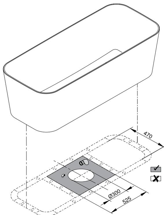
Dimensiones de conexión para desagüe/rebosadero
