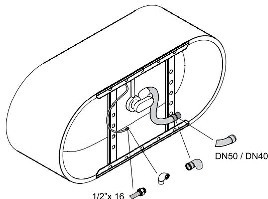
Dimensiones de conexión para desagüe/rebosadero
