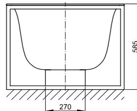
Dimensiones de conexión para desagüe/rebosadero
